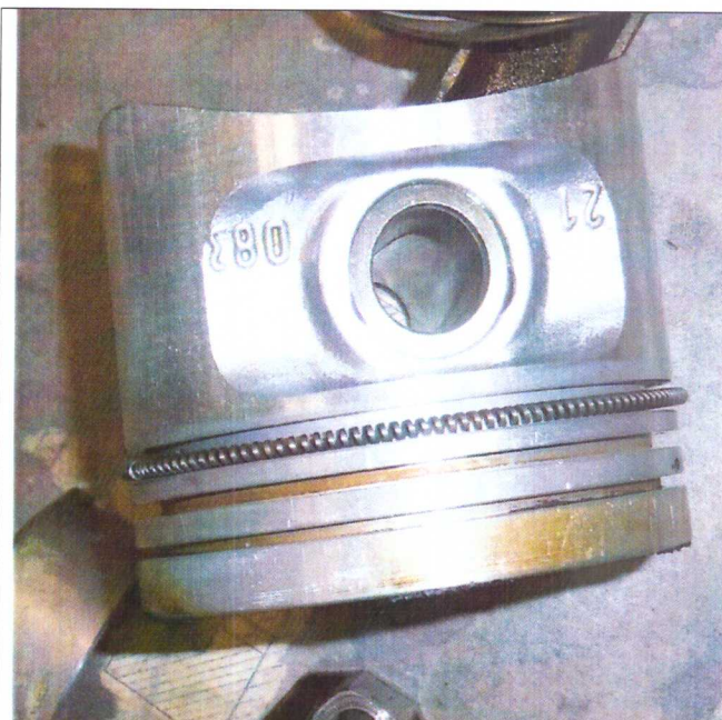
Рис.6. Внешний вид боковой поверхности поршня первого цилиндра по окончании длительных испытаний двигателя при работе на базовом масле Castrol EDGE
