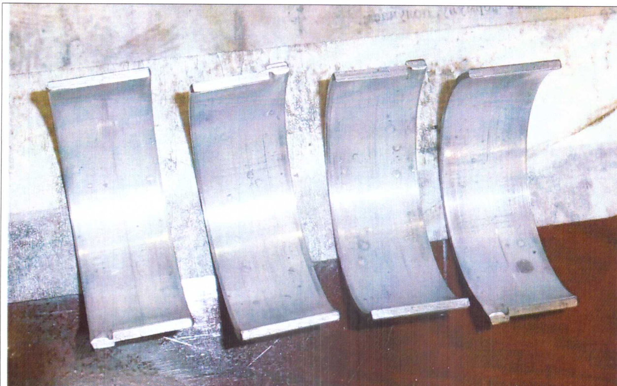
Рис.П1-19. Внешний вид рабочей поверхности верхних вкладышей шатунных подшипников коленчатого вала по окончании длительных испытаний двигателя при работе на базовом масле Castrol EDGE
