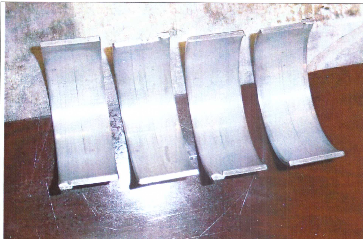
Рис.П1-17. Внешний вид рабочей поверхности нижних вкладышей шатунных подшипников коленчатого вала по окончании длительных испытаний двигателя при работе на базовом масле Castrol EDGE
