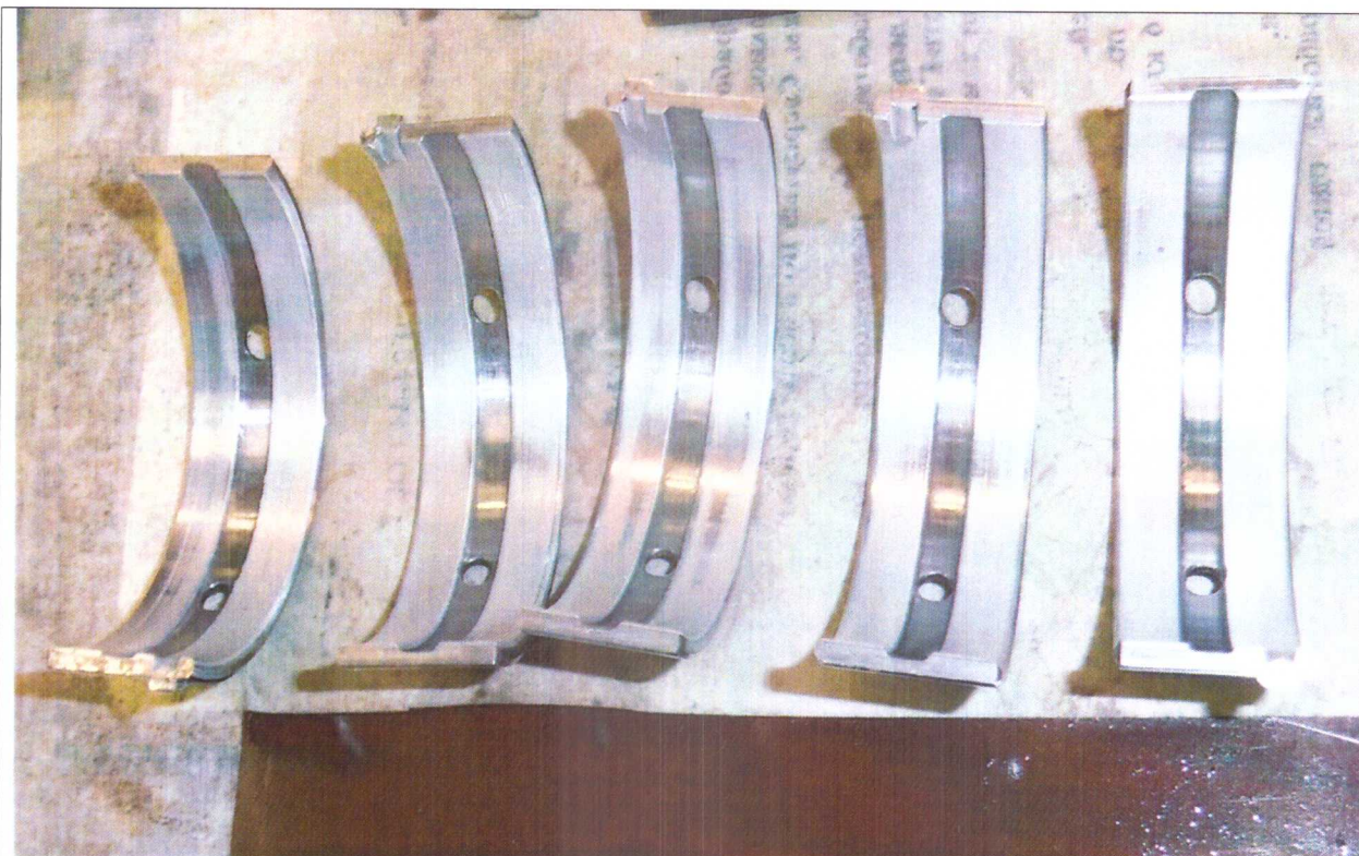
Рис.П1-15. Внешний вид рабочей поверхности верхних вкладышей коренных подшипников коленчатого вала по окончании длительных испытаний двигателя при работе на базовом масле Castrol EDGE
