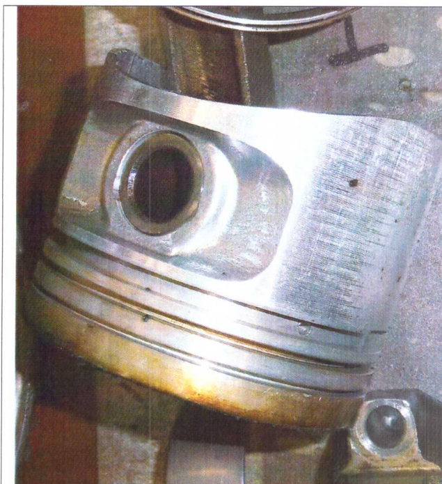
Рис.П1-9. Внешний вид боковой поверхности поршня третьего цилиндра по окончании длительных испытаний двигателя при работе на базовом масле Castrol EDGE
