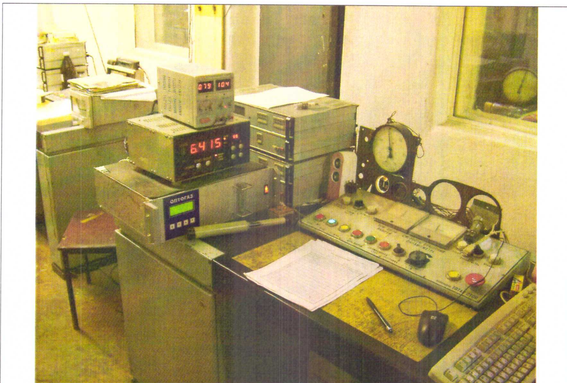
Рис. 2. Пульт управления стендом. Расходомер топлива и газоанализатор.
