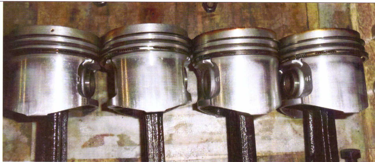
Рис. П2-2. Общий вид боковых поверхностей поршней двигателя после аварийного цикла испытаний. Двигатель, обработанный наноккомпозитом Amortect PROOF.
