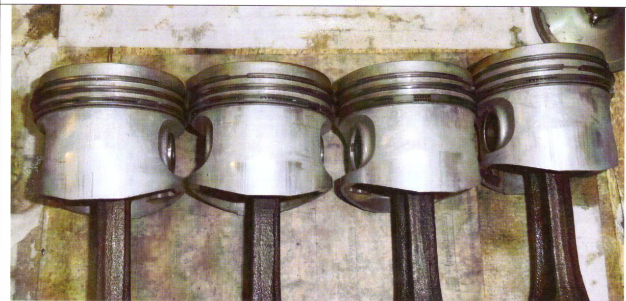
Рис. П1-2. Общий вид боковых поверхностей поршней двигателя после аварийного цикла испытаний. Базовый двигатель.
